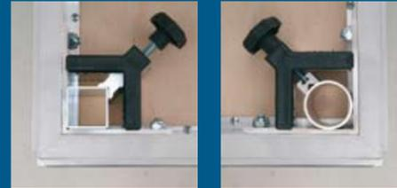
**Tube carré** d'une section de 40 x 40 mm à 45 x 45 mm ou de 55 x 55 mm à 60 x 60 mm
